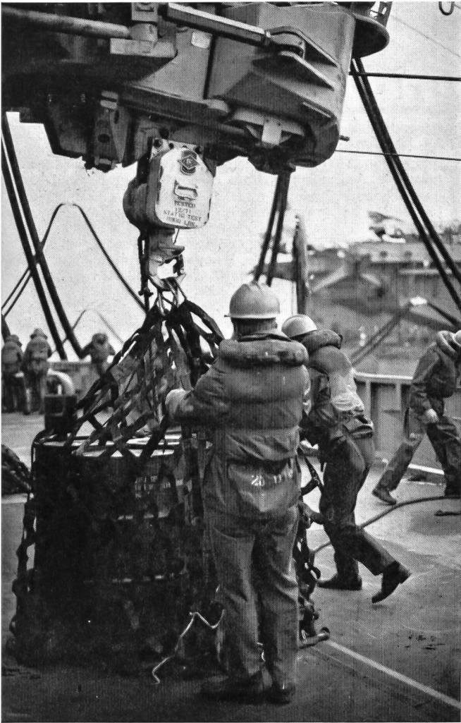
innen in bunten Helmen und mit Schwimmweste befestigen die mit Gütern ladenen Netze an den Laufkatzen, die dann von der «Seattle» zur «Ken- dy» gefahren werden. Im Hintergrund sieht man diverse Ölleitungen.
