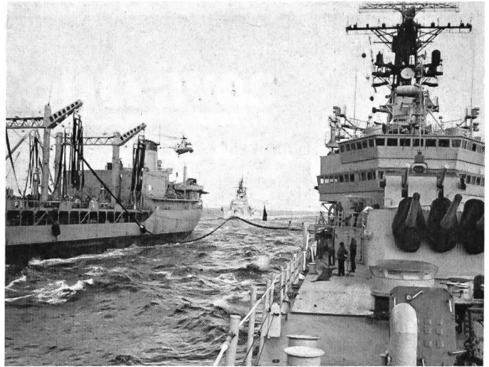
Underway Replenishment. Der Tanker «Neosho» der 6. Flotte hat Leinen- verbindungen mit dem Flaggschiff, dem Kreuzer «Little Rock», hergestellt. Während Stunden fließt das kostbare Öl durch die Schlauchleitungen in die Bunker. Währenddessen setzt ein Sea-King-Helikopter einen Matrosen auf dem Heck des Tankers ab, und der Zerstörer «USS Manley» schiebt Wache im Hintergrund. Beachte den schweren Drillingsturm der «Little Rock» mit 15,2-cm-Geschützen, den Zwillingturm mit 12,7-cm-Rohren (wie auf der «New») und die zwei breiten Kommandodecks (das untere für den Flottenstab, das obere für das Schiffskommando).
