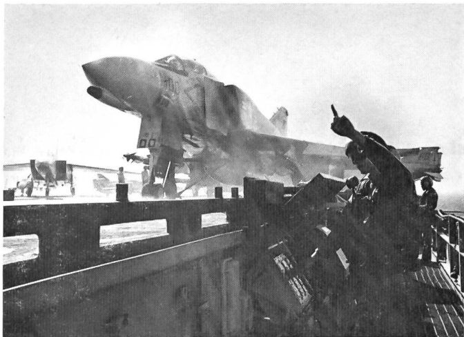
Ein Phantom-Jagdbomber der VF-14 befindet sich auf Katapult Nr. 4. Seine Triebwerke laufen auf Höchststouren. Das Verbindungsstahlseil, das die Maschine am Katapult nach vorne reisst, ist unter dem Rumpf deutlich zu sehen. Der Matrose vorne im Gehsteig (Cat-walk), der rund um das Flugdeck führt, verständigt sich mit Handzeichen mit dem Katapultoffizier. Wenn alle Checks erfolgt sind, wird er auf einen Knopf drücken und die Phantom wird in die Luft geschleudert. Hinten wartet bereits eine Vigilante-Aufklärungsmaschine auf den Start.
