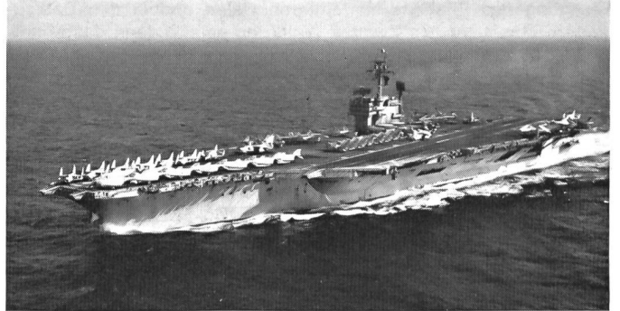
Der Flugzeugträger «USS John F. Kennedy» in voller Fahrt im Mittelmeer. Deutlich ist der nach rechts versetzte Kommandoturm, auch Insel genannt, mit seinen vielen Antennen- und Elektronikausrüstungen erkennlich. Das Schiff verfügt auch über eine moderne U-Boot-Ortungseinrichtung (Sonar).
