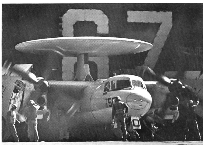
Eine E-2 B Hawkeye der VAW-125 macht sich zum Start bereit. Markant ist die grosse Radarantenne über dem Rumpf. Die Besatzung einer Hawkeye setzt sich aus Pilot, Copilot, zwei Radareinsatzoffizieren und einem Technikerunteroffizier zusammen. Die Maschine operiert in der Regel einige hundert Kilometer vom Träger entfernt und verlängert dadurch die Reichweite der Erkennungsmittel zur Ortung gegnerischer Objekte. Die Maschine kann zudem direkt Kampfflugzeuge, deren Radarreichweite begrenzt ist, auf die richtige Spur setzen.
