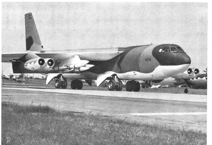
Ein B-52-Bomber im Tarnanstrich und mit SRAMs an den Aussenstationen rollt zum Start. Die riesige Maschine hat ihr Hauptfahrwerk im Rumpf, während an den äusseren Enden der Tragflächen nur kleine Stützräder ausgefahren werden können.
