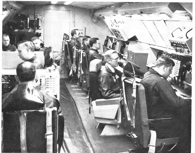
Das SAC hat jahraus, jahrein einen fliegenden Kommandoposten im Einsatz, der im Falle einer Zerstörung der Bodenorganisation eine Kontinuität der SAC-Missionen gewährleistet. Es handelt sich dabei um eine EC-135C, welche eine spezielle Version der zivilen Boeing 707 ist. An Bord ist stets ein Offizier im Generalsrang (zweiter von rechts).
