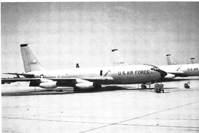
K-135-Tanker auf der Flight-line der Pease AFB in New Hampshire. Über 600 Maschinen dieses Typs besorgen das Auftanken der SAC-Bomber und der übrigen Flugzeuge der US Air Force. Die Möglichkeit, diese Maschinen innert kurzer Zeit zu Mannschaftstransportern umbauen zu können, eröffnet der US Air Force eine willkommene Vermehrung der Transportkapazitäten.
