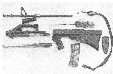
Das Stg 77, das in der Hauptsache aus Kunststoff hergestellt wird, kann ohne Werkzeug zerlegt und zum grössten Teil mit Wasser gereinigt werden.
