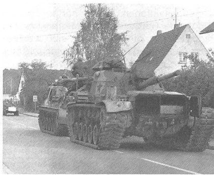
Ein Bergepanzer M-88 schleppt einen havarierten Kampfpanser M 60 A 1 ab.
