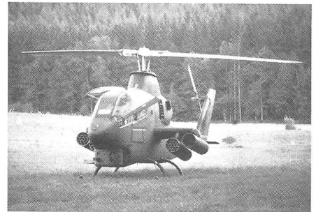
Das Hauptkampfmittel der 101. Air Assault Division: die AH-1 G Cobra, ein Helikopter zur Bekämpfung von Panzern. Hier ist eine solche Maschine auf einer improvisierten Basis gelandet und wartet den nächsten Einsatzbefehl ab. Beachte die seitlich angebrachten Behälter für je 19 Raketen (ungelenkt, 70 mm) sowie das unter der Nase angebrachte schwenkbare Mg (7,62 mm) und den 40-mm-Granatwerfer.
