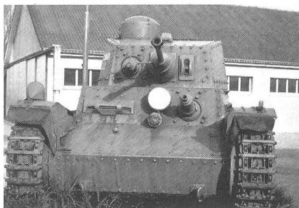
Bewaffnung: — 1×24-mm-Kanone; Vo: 900 m/Sek. — 2×Panzer-Mg 38; Kadenz: über 1000 Schuss/Min.
