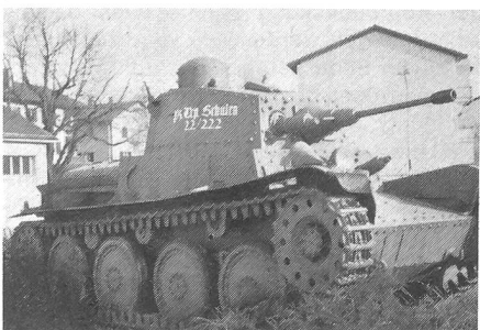
Panzerung: — Turm vorn 30 mm, Seite 20 mm — Wanne vorn 30 mm, Seite 20 mm, hinten 15 mm Besatzung: 3 Mann Abmessungen: Länge: 4,8 m; Breite: 2,2 m; Gewicht: 13 t
