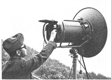
Das Richtstrahlnetz bildet das Hauptverbindungsnetz an der Übung ECHO 77. Unser Bild zeigt ein Gerät R-902 im Einsatz.
