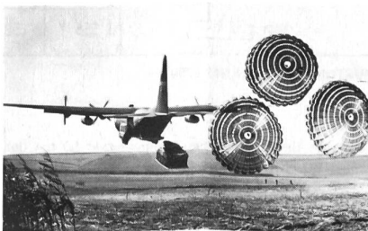
Absetzen eines Panzers mit Hilfe von drei Fallschirmen aus dem geöffneten Heck einer C-130 Hercules des MAC.
