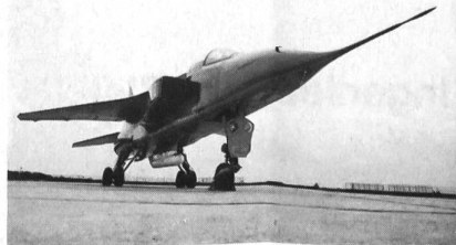
Für die Einsatzsteuerung der AS 30L dient diese an der zentralen Unterrumpstation mitgeführte ATLIS II-Kampfmittelleitanlage für die Zielauffassung, -verfolgung und die -beleuchtung mit einem Laserstrahl
