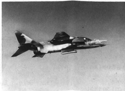
Start einer AS 30L ab einem Jaguar Erdkämpfer während eines Einsatztests. Gut sichtbar ist der elektro-optische ATLIS II-Pod für die Zielauffassung und den Waffeneinsatz
