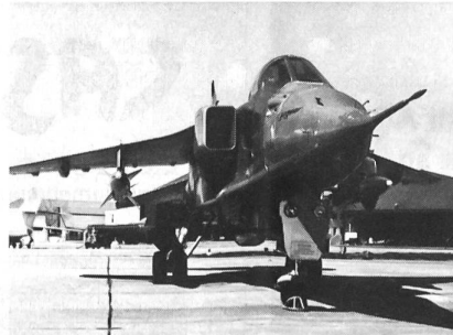
Ein mit zwei lasergesteuerten Luft/Boden Lenkflugkörpern des Typs AS 30L bestückter Jaguar A der Armée de l'Air
