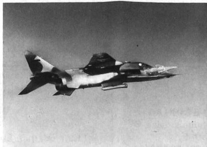
Start einer AS 30L ab einem Jaguar Erdkämpfer während eines Einsatztests. Gut sichtbar ist der elektro-optische ATLAS II-Pod für die Zielauffassung und den Waffeneinsatz
