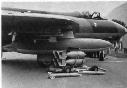
Der Hunter in der Rolle als Erdkampfflugzeug. Er kann Bomben und Raketen mitführen. Ausserdem besitzt er 4 30-mm-Kanonen.
