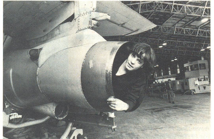
Die schlanke Gila schlüpft zur Kontrolle der Innenseite in die verrusste Düse
