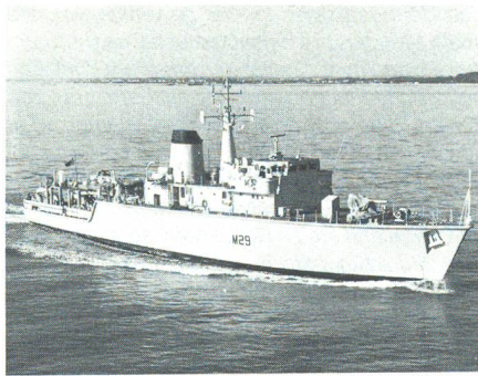
England zählt zu den führenden Nationen auf dem Minenkriegssektor. Dies ist um so wichtiger, als die amerikanische Marine praktisch keine aktiven Minenschiffe mehr besitzt. Hier ist die HMS «Brecon» zu erkennen, Leitschiff einer 12 Einheiten umfassenden neuen Klasse (Verdrängung 725 t). Bemerkenswerteste Neuheit an diesem Schiff ist dessen Glasfibernumpf. Der Minensucher ist mit einer 40 mm Kanone bewaffnet.
