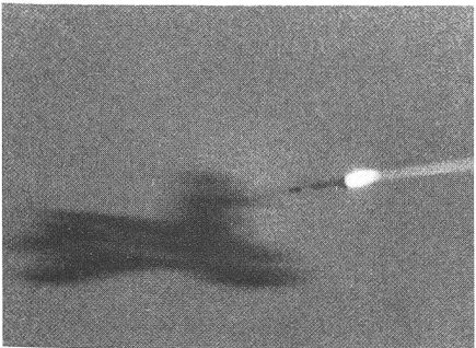
Die mit halbaktivem Radar ausgerüstete Sparrow-Lenkaffe trifft das Ziel. Von den drei abgeschossenen Lenkaffen wurden zwei direkte Treffer erzielt, und die dritte Lenkaffe passierte das Ziel innerhalb des Wirkungsbereiches des Kriegskopfes.
