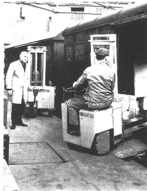
SIG-LIFTER Elektro-Pratzenstapler mit Quersitz- oder Deichsellenkung
