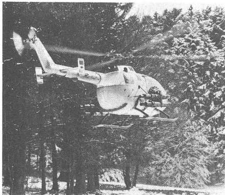
MBB erprobte auf dem Meppen-Schiessgelände der Bundeswehr einen TOW-Panzerabwehrwaffen bestückten BO-105CB-Versuchsträger im scharfen Schuss. Alle elf über den ganzen BGM-71-Einsatzbereich verschossenen TOW-Flugkörper trafen ihr Ziel. Beim integrierten Beobachtungs- und Zielgerät handelt es sich um die gleiche Anlage, wie sie bei den Lynx-Drehflüglern der British Army verwendet wird. Verschiedene Staaten, darunter auch die Schweiz, zeigen Interesse an einer TOW-Pal bestückten BO-105, weshalb MBB die Firma Hughes Aircraft Company mit der Systemintegration beauftragte. ka
