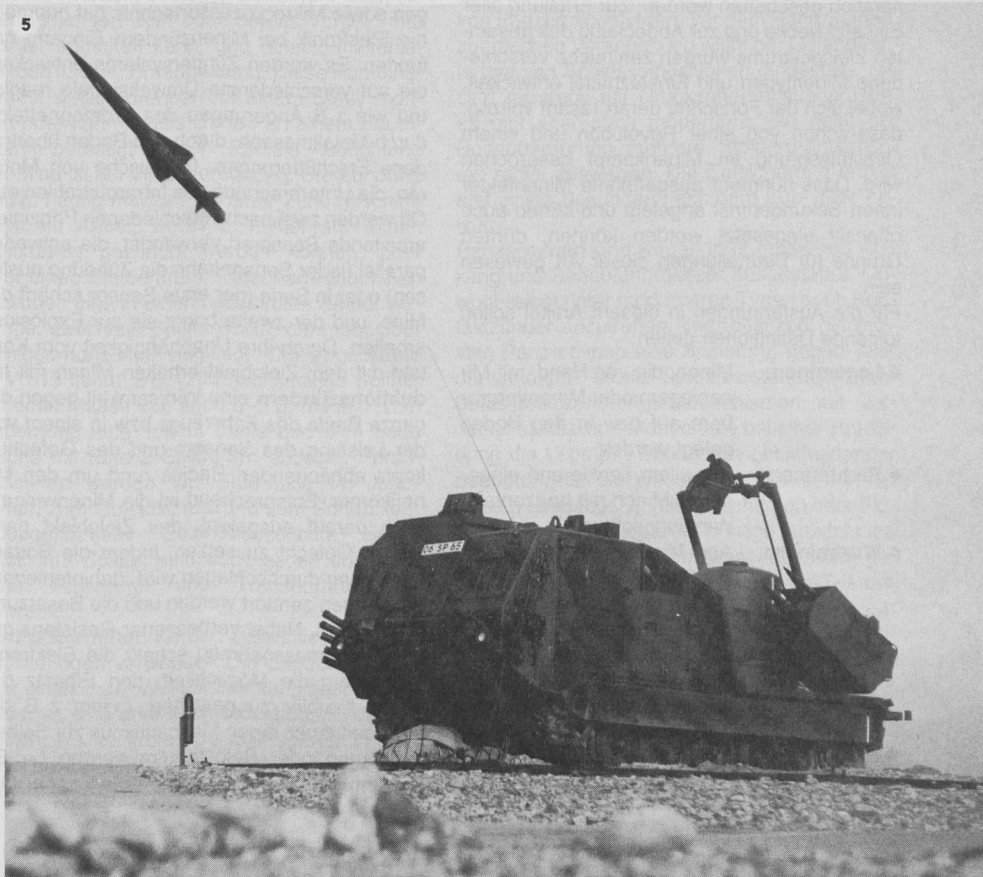
1 Abschuss einer Rapier Lenkwaffe. Am linken Bildrand sieht man das Blindfire Zielfolgeradar.
