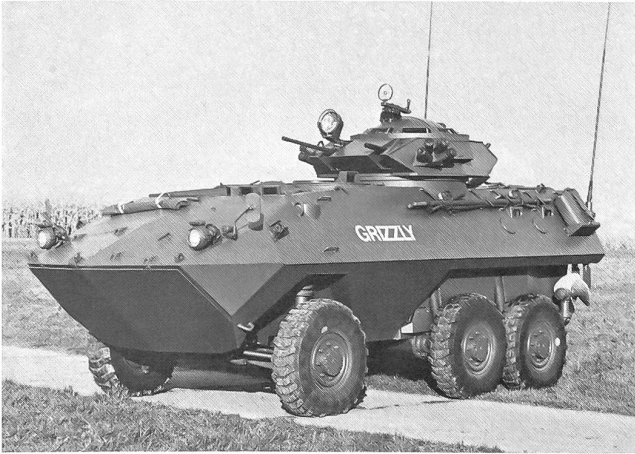
Piranha 6x6 «Grizzly» der kanadischen Streitkräfte. Am Heck sieht man deutlich einen der beiden Propeller, die dem Panzer im Wasser eine Geschwindigkeit von 10 km/h verleihen.
