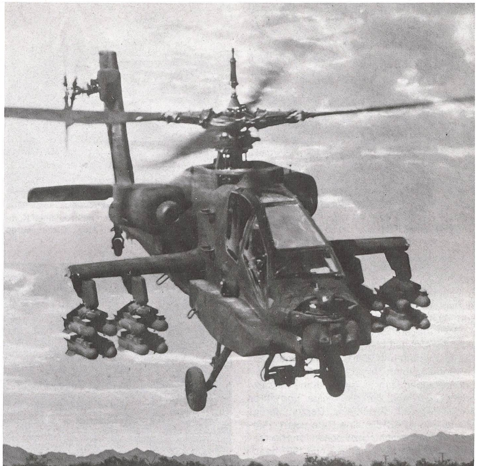
Erstmaliger Einsatz der US «Gunships» in Europa. MDHC AH-64 A «Apache» stärkster Allwetter- und Nacht-kampf-Kampfhubschrauber, hier auf dem Bild mit M 230 30 mm Chain Gun (MKan) und 16 Hellfire ATFK (Pzaw-Waf).
