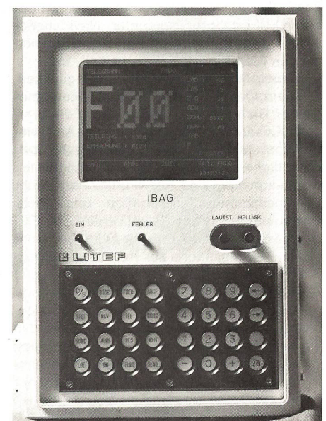
Bedienungsgerät der Navigations- und Rohrrichtanlage. Einfache Bedienung. Alles auf einem Bildschirm vereint. Feuerkommando, Navigation, Rohrrichtanlage, Feuerbefehl (Werkfoto Firma «Lifef»).
