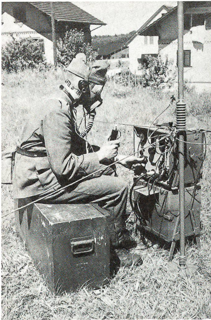
TL-BBC/SE-212, Verbindung Flugzeug-Erdtruppe sowie Kdo- und Fernüberwachungsverbindungen der Schweren Flab im Aktivdienst 1939–1945 Bild aus der Festschrift
