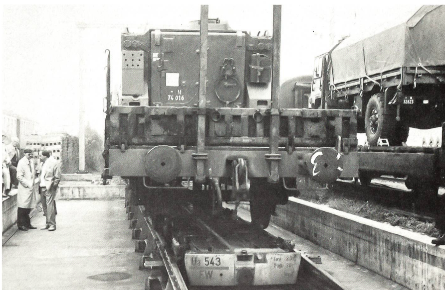
Ein auf einem Tiefladewagen der SBB verladener Schützenpanzer, auf Rollböcken vorbereitet zur Fahrt auf Schmalspur. Rechts im Bild ist die Arretierung mit einem neuen Metallkeil für PneuFahrzeuge erkennbar.
