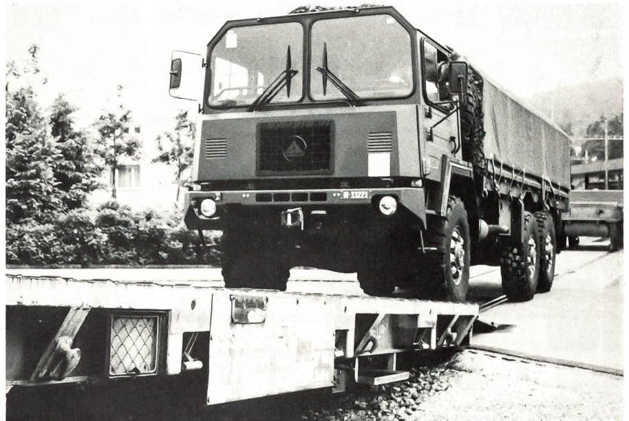
Bei den Vorführungen der Eisz Betr Gr 3 wurde auch das Verladen mittels eines Rampenwagens «SMPS» durchgeführt. Das Bild zeigt die Auffahrt des Saurer-Lastwagens 10t, 6x6. Über den Rampenwagen können ganze Züge auf offener Strecke mit Fahrzeugen beladen werden.
