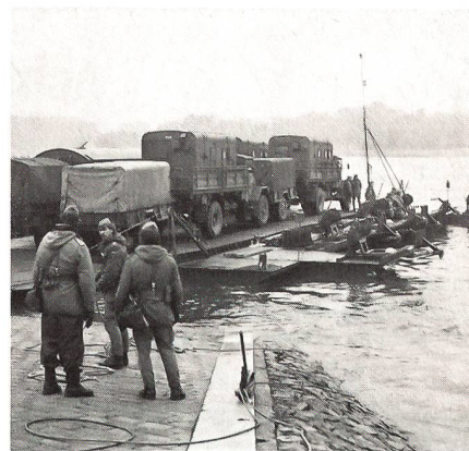
Mit Kriegsbrückengerät – im Bild als Fähre – sind die Schwimmbrückenbataillone des TerrHeeres ausgerüstet.
