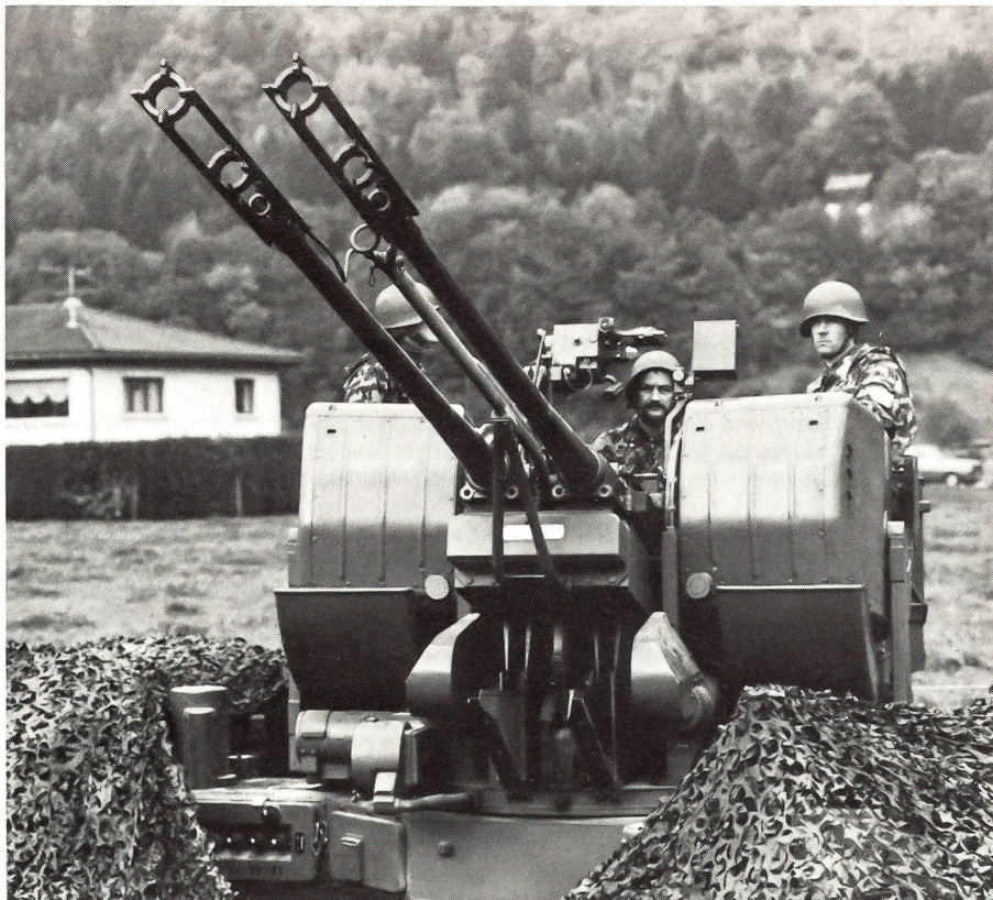
Den Schutz der Behelfspiste übernehmen im Rahmen einer Übung Einheiten eines Flab-Regimentes, die unter anderem auch durch Skyguard-Feuereitgeräte kontrollierte 35-mm-Kanonen einsetzen.
