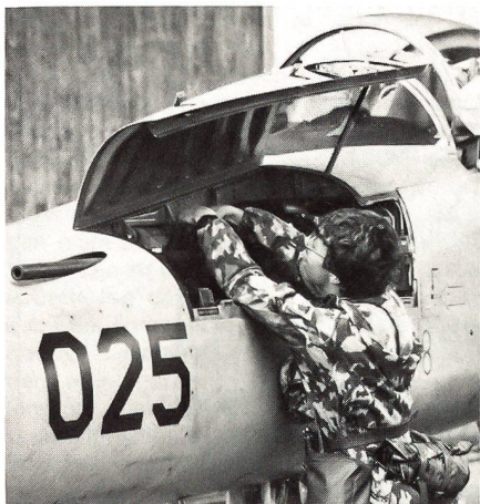
Ein Waffenwart beschäftigt sich mit einer der beiden 20-mm-Bordkanonen eines Tigers.
