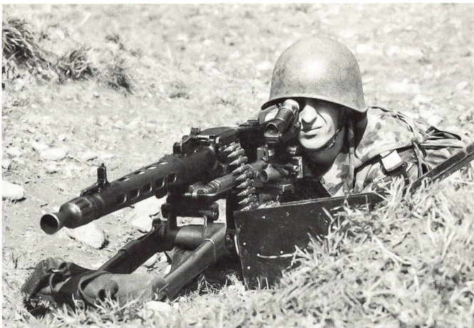
Maschinengewehr Kaliber 7,5 mm, Gewicht 17 kg ohne Lafette, 42 kg mit Lafette, Schussfolge 1000 Schuss/Minute, praktische Schussweite 1200 m. Munitionszufuhr: Gurte à 200 Schuss, Trommelmagazin à 50 Schuss.
