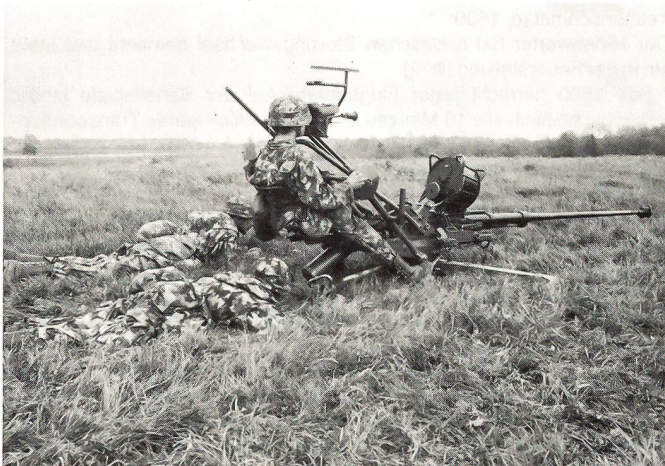
20-mm-Fliegerabwehrkanone zum Erdzielbeschuss bereit. Feuergeschwindigkeit 1000 Schuss/Minute. Munition: Minenbrandgranate, Panzerbrandgranate (Leuchtspurgeschoss). Praktische Schussweite 2000 m, Geschützgewicht 380 kg.
