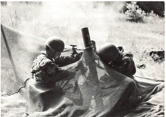
8,1-cm-Minenwerfer Gewicht: Rohr 21 kg, Lafette 18 kg, Grundplatte 21 kg Feuergeschwindigkeit: 15 Schuss/Minute. Munition: Wurfgranate (3,3 kg), Wurfmine (6,9 kg). Ferner Nebelgranate und Beleuchtungsgeschoss. Höchstschussweite: Wurfgranate 4 km, Wurfmine 1 km
