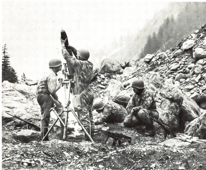
12-cm-Minenwerfer in Feuerstellung. Gewicht 239 kg, Schussweite 7,5 km, 3–4 Mann Bedienung, Feuergeschwindigkeit ca 6 Schuss/Minute. Munition: • 12-cm-WG, Gewicht 15,2 kg, Momentan-Verzögerungszünder (MVZ) • 12-cm-Beleuchtungsgeschoss
