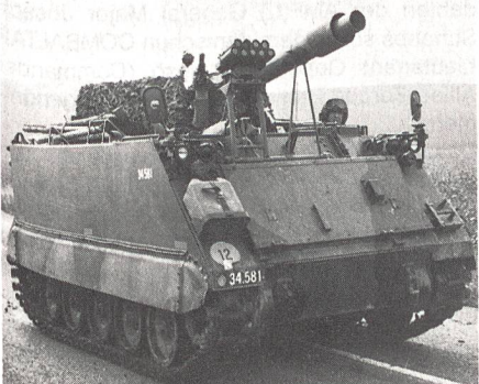
Dänischer Schützenpanzer M-113 mit einer Kanonenrohrtrappe. Stellt für das Manöver einen Centurion dar.
