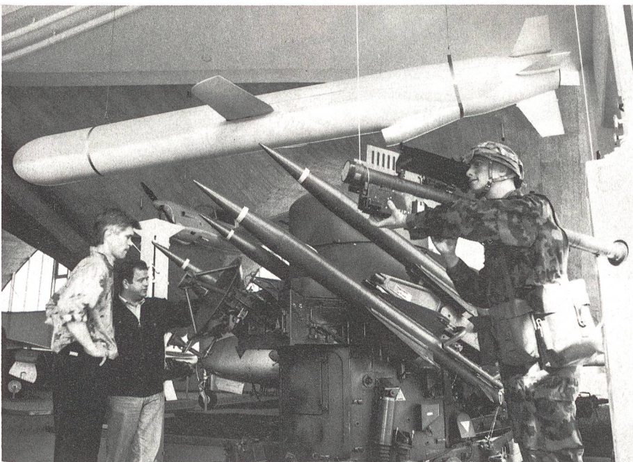
Moderne Flab-Lenkwaaffe «Stinger» und «Rapier» der Schweizer Armee. Oben im Bild eine Cruise Missile «Tomahawk», wie sie von der US Navy im Golfkonflikt eingesetzt wurde.
