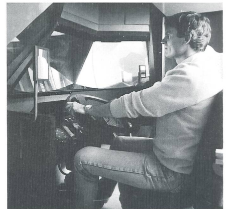
Nachgebildete Führerkabine mit Frontsichtprojektion und der Rückspiegel-Anordnung.
