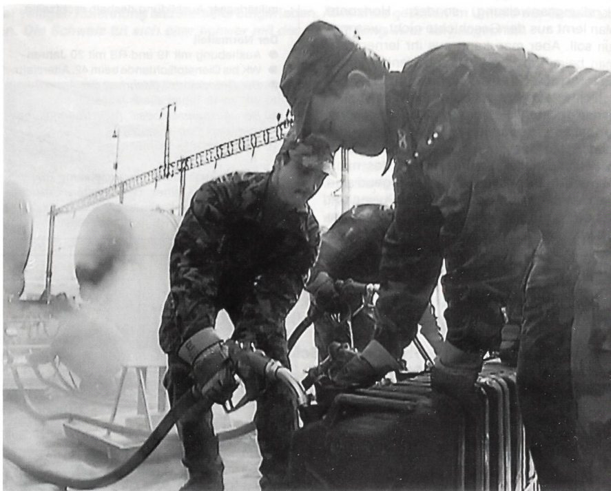
Abfüllen von Betriebsstoffkanistern ab Eisenbahnzisternen.
