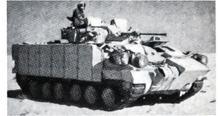
Britischer Warrior mit Zusatzpanzerung (Golfkrieg).
