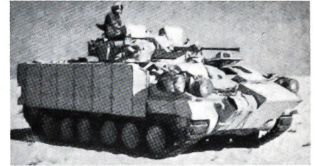
Britischer Warrior mit Zusatzpanzerung (Golfkrieg).
