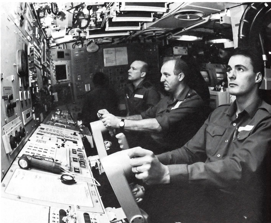
Der Kontrollraum des U-Bootes «HMS Vanguard». Diese drei Seeleute steuern, unter Aufsicht des diensthabenden Offiziers, das riesige Raketen-U-Boot. Dieses ist unter Wasser in allen drei Dimensionen, ähnlich den Bewegungen eines Flugzeuges, zu steuern.
