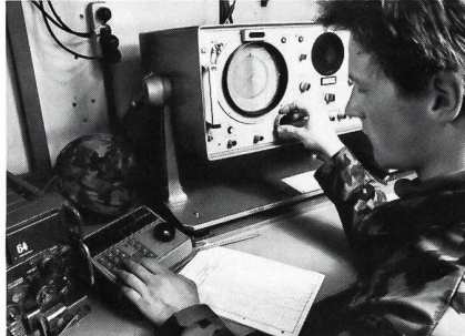
Mittels Funkpeilung werden Standorte fremder Sender bestimmt. Foto: BAUEM, SID
