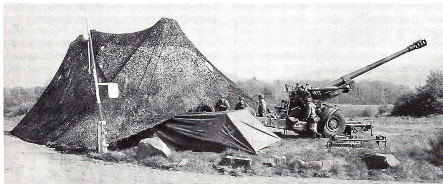
Feldhaubitze FH 155-1. Bedienung 8 Mann, Kaliber 155 mm, Schussweite 24/30 km, 6 Schuss pro Min, ein Hilfsantrieb ermöglicht Beweglichkeit im Stellungsraum.
