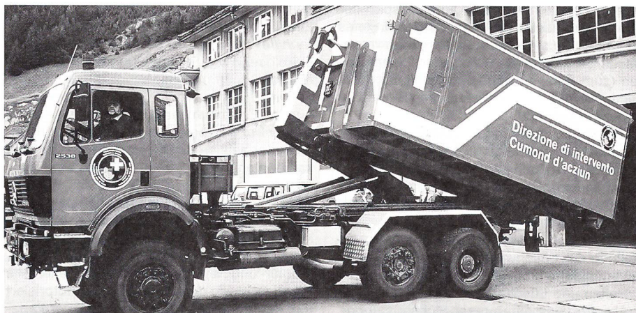
Ausbildung Auf- und Abladen eines Wechselladerbehälters (WELAB)
