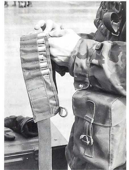
Eingurten der Patronen, welche im Rohrverschluss die Geschossladungen zur Zündung bringen.
