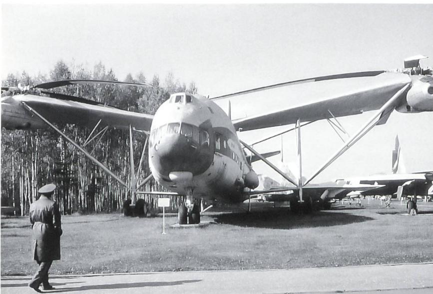
Mi-12, ein schwerer Transporthelikopter, Nutzlast: 40 Tonnen.
