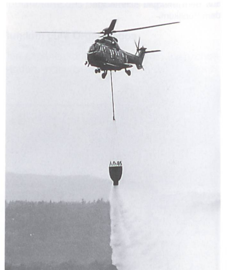
Auch für Löscharbeiten hat sich der Superpuma bestens bewährt. Er kann 2500 Liter Wasser mit sich führen, was doch schon eine ganze Menge ist.
