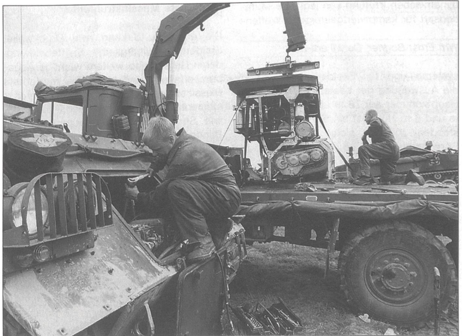
Motorpanne im Feld. Auf dem Bild: Auswechseln eines ganzen Motors im Feld.
