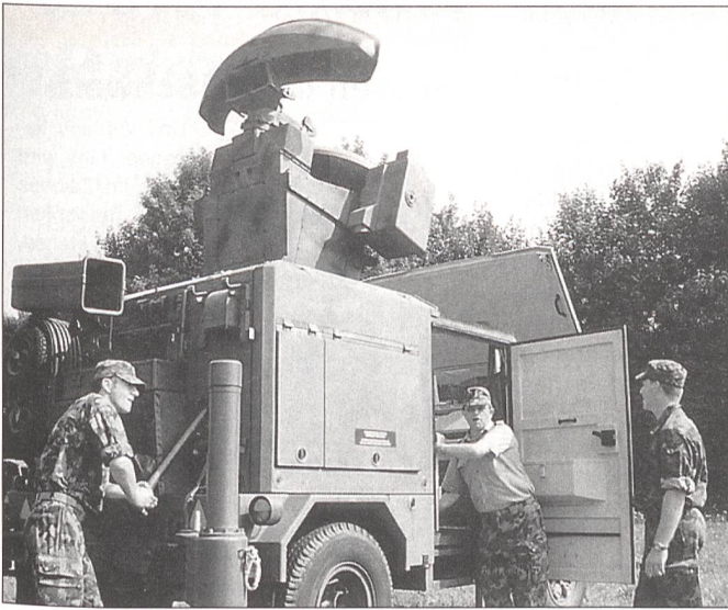
Übungshalber von Hand. Das Feuerleitgerät Flt Gt 75/95 der Oerlikon-Contraves wird eingerichtet. Durch Pumpbewegungen wird das Richtgerät in Arbeitsstellung gebracht. Adj Uof Erwin Süssli aus Uster gibt entsprechende Anweisungen.
