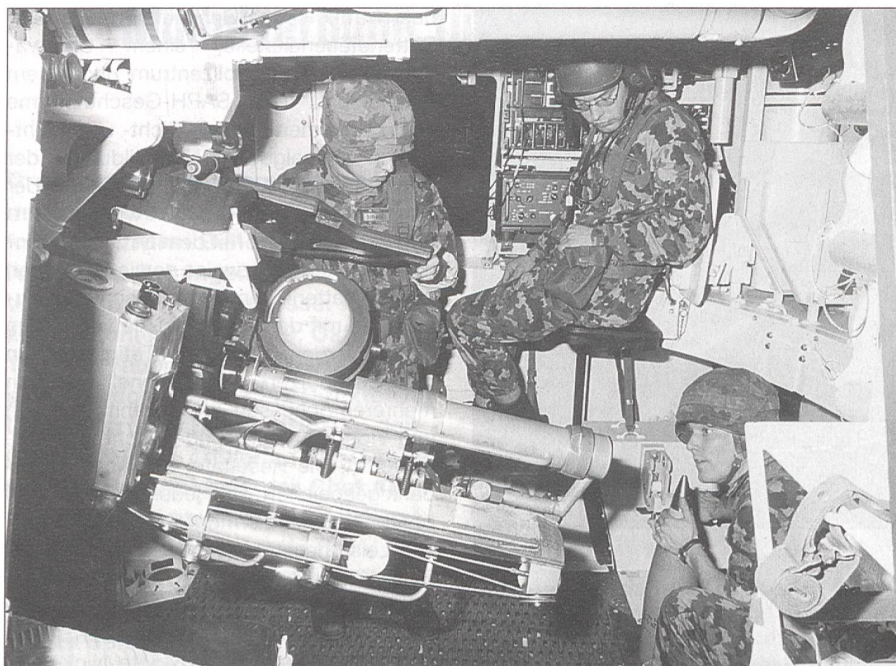
Mit Ausnahme des Fahrers arbeiten alle Chargen wie beim Echtgeschütz. Sämtliche Tätigkeiten werden mit Sensoren und wie im Bild mit Video überwacht.
