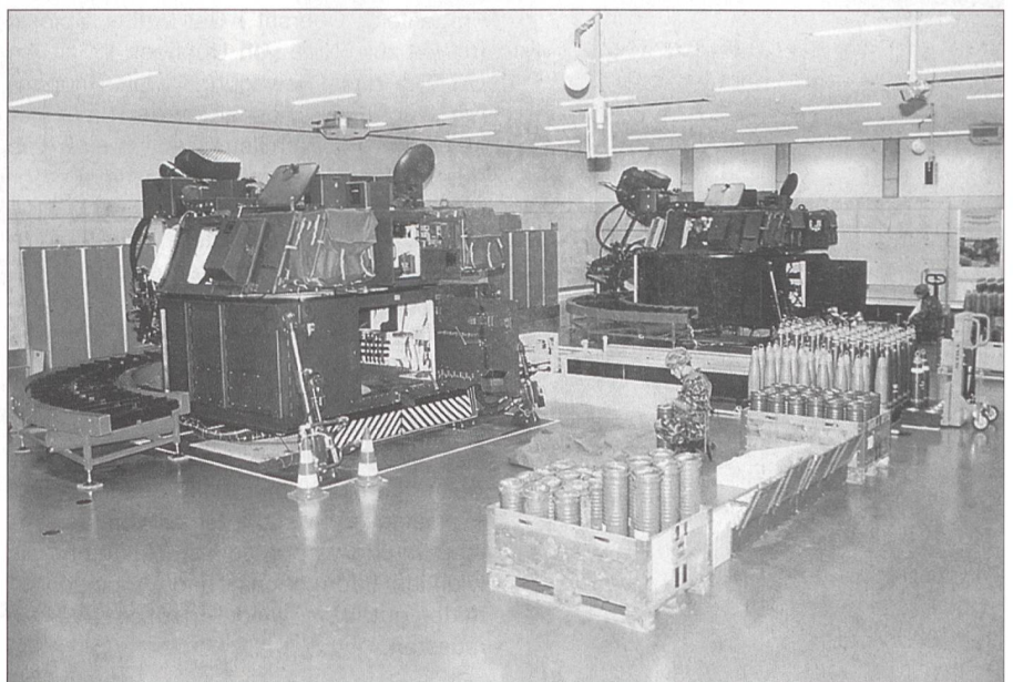
Zwei der sechs Pz-Hb-M-109-Geschütztürme der Simulatorenanlage SAPH 88 mit der bereitgestellten Munition.
