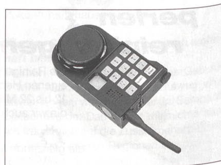
Die Masterbox ist der Computer des Soldaten. Er empfängt das kodierte Laserlicht und sendet den kodierte Funkimpuls «IFF» zurück an den Absender.
