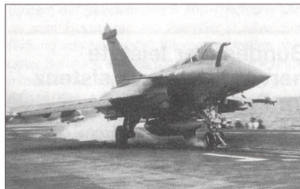
Dassault Rafale bei Katapultversuchen.
