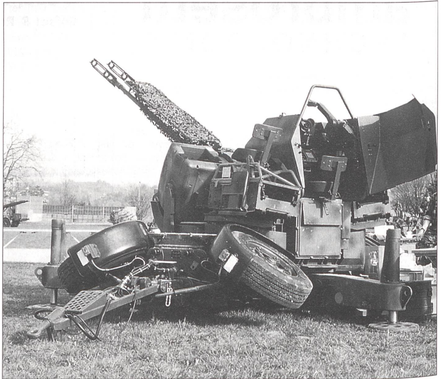
35-mm-Flab-Kanone, vollautomatisches Zwillingsgeschütz mit 4000 m Wirkungsdistanz und total 7700 kg Gewicht.
