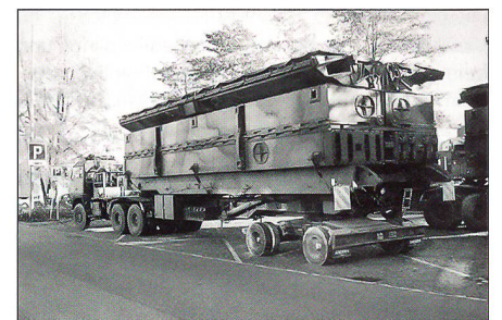
Ein einzelnes verladenes 10 Meter langes und 11 Tonnen schweres Modul.
