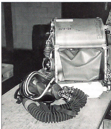
Das Kreislaufgerät 84 (KG 84) bietet Schutz und den nötigen Sauerstoff für vier Stunden. Das Gewicht von 14,5 kg bedingt für die Träger zunächst einen Fitnessstest.
