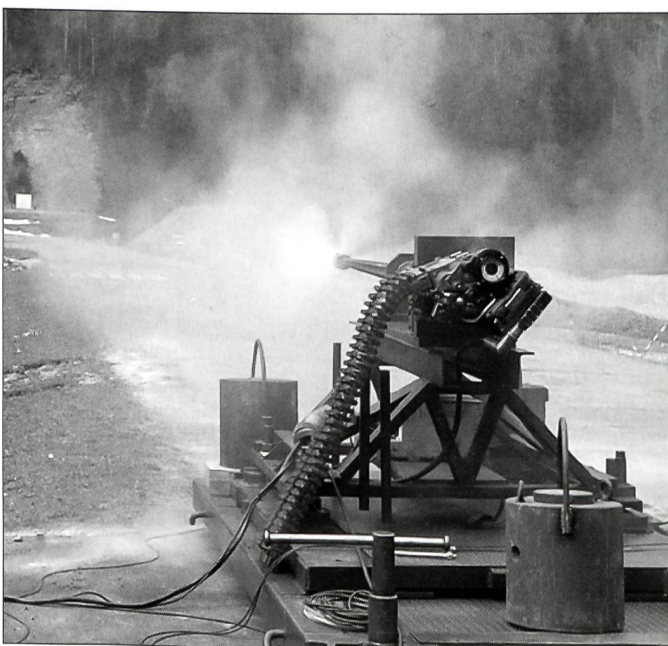
Gut erkennbar die Leuchtspur der Pfeilmunition links im Bild kurz vor dem Ziel.
