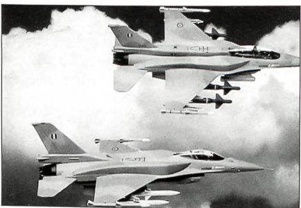
F-16 C/D der griechischen Luftwaffe (künstliches Bild); beachtenswert sind die Conformal Fuel Tanks auf der Rumpfoberseite.
