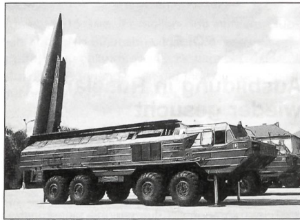
Transport-/Startfahrzeug 24 Tonnen (8x8) 9P71 mit Rakete in Startposition.
