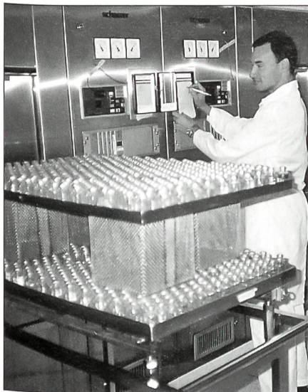
Der Sterilisator-«Chef» checkt den Schreiberstreifen, um die Einhaltung der Parameter bei der Keimtötung zu überprüfen.
