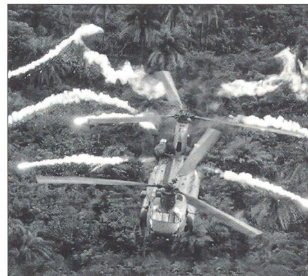
Mittelschwerer Transporthubschrauber Boeing Chinook HC Mk.2 der RAF, ausgerüstet mit Miniguns und Flares.
