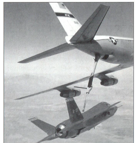
Luftbetankung einer Lockheed X-35 durch eine KC-135.
